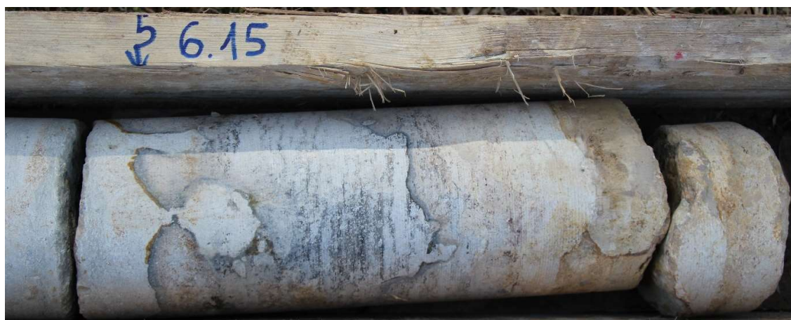
Foto 4.2. Kolmekordne püriitse ja fosfaatse impregnatsiooniga taskutega katkestuspind puuraugus Pa-3.
